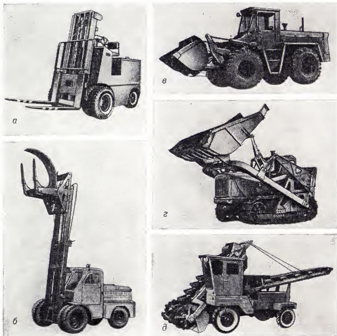
Основные виды погрузчиков: а — вилочный электропогрузчик общего назначения; б — специальный автопогрузчик для длинномерных грузов; в — колёсный одноковшовый погрузчик; г — гусеничный одноковшовый погрузчик с задней разгрузкой ковша; д — многоковшовый погрузчик непрерывного действия с питателем.
